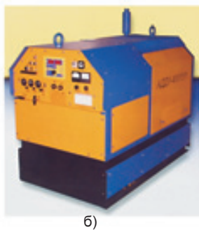
Рис. 5. Микропроцессорные выпрямители ВДУ (МТ) нового поколения для сварки трубопроводов (а) и агрегаты сварочные дизельные универсальные АДДУ с микропроцессорным управлением (б)
