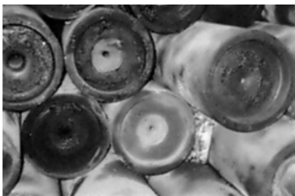
Рис. 5. Поломки роликов по шейкам
