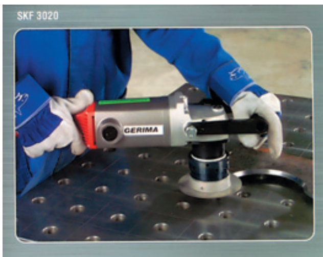
Рис. 26. Ручная машина SKF3020 для снятия фасок с прямолинейной и криволинейной поверхностей
