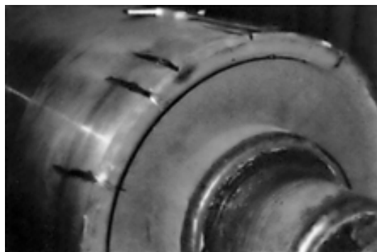
Рис. 3. Разделка глубоких трещин разгара
