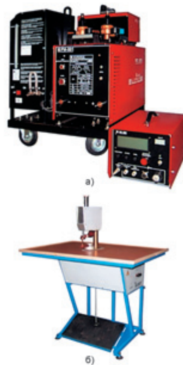
Рис. 4. Пост для ручной дуговой сварки ПРС-501Э (а) и машина для контактной точечной сварки миниатюрных деталей для приборостроительной и электротехнической промышленности УК-0501 (б)
