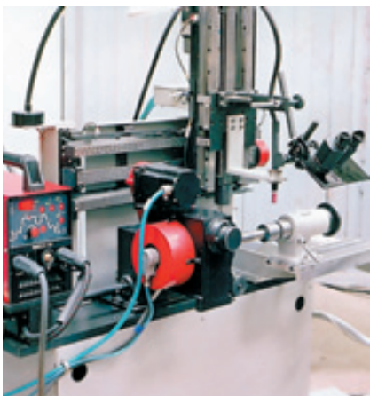
Рис. 8. Установка УСК-50 для аргонодуговой сварки кольцевых швов
