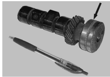
Рис. 7. Распределительный вал ДВС после ремонта методом электронно-лучевой наплавки (стрелкой указано место износостойкой наплавки)
