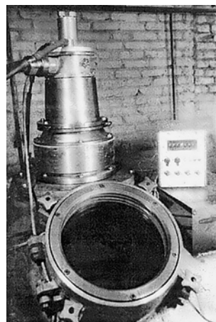
Рис. 3. Заводская электронно-лучевая установка с пушкой с "холодным катодом" и прибором управления лучом
