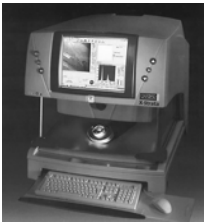
Рис. 9. Рентгенофлуоресцентный анализатор покрытий X-Strata 960 для качественного и количественного анализа различных материалов
