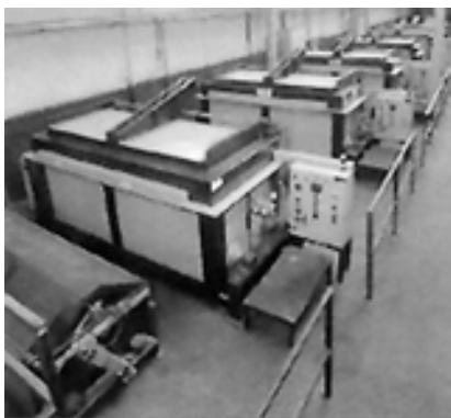
Рис. 12. Линия для термодиффузионного цинкования на основе печи "ДИС-ТЕК 450" со сменной ретортой (загрузка до 600 кг)
