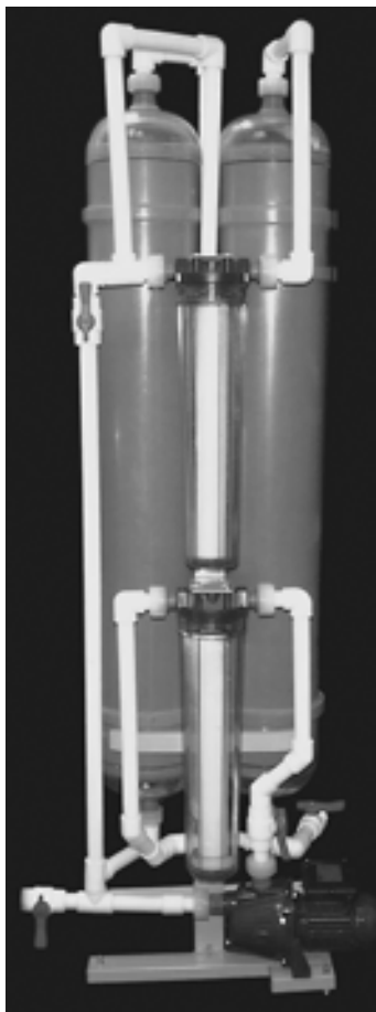
Рис. 7. Установка для регенерации промывочных вод УРПВ-2
