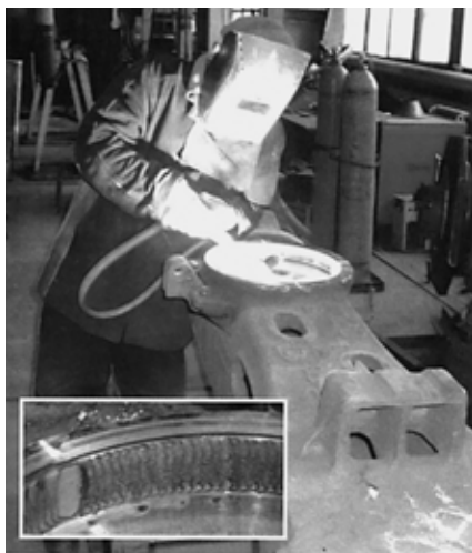
Рис. 12. Ручная плазменная закалка бурта подпятника железнодорожного вагона с фрагментом закаленной поверхности
