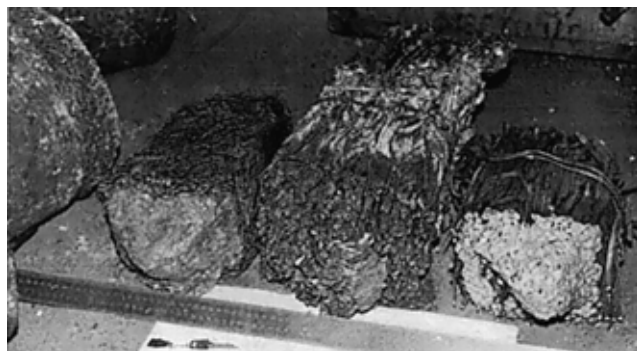
Рис. 1. Внешний вид оплавленных торцов расходуемых электродов при переплаве отходов меди из спрессованной тонкой проволоки (слева), не очищенной от покрытия шинки (в центре) и очищенной шинки (справа)
