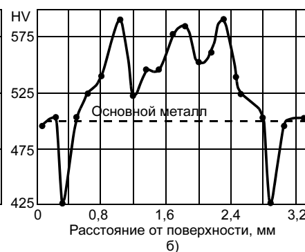
Рис. 8. Распределение твердости по глубине (а) и ширине закаленной дорожки на глубине 0,3 мм (б) при плазменной закалке стали 5XHM
