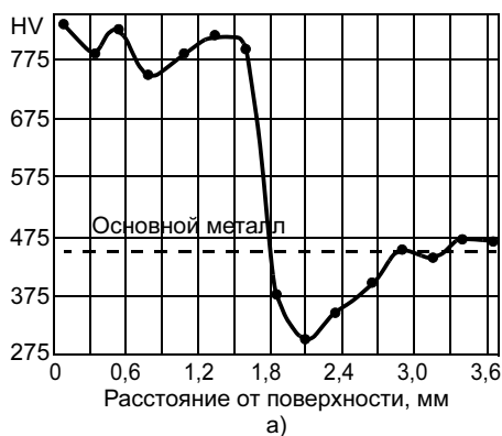
Рис. 6. Распределение твердости по глубине (а) и ширине закаленной дорожки на глубине 0,3 мм (б) при плазменной закалке стали 5XB2C
