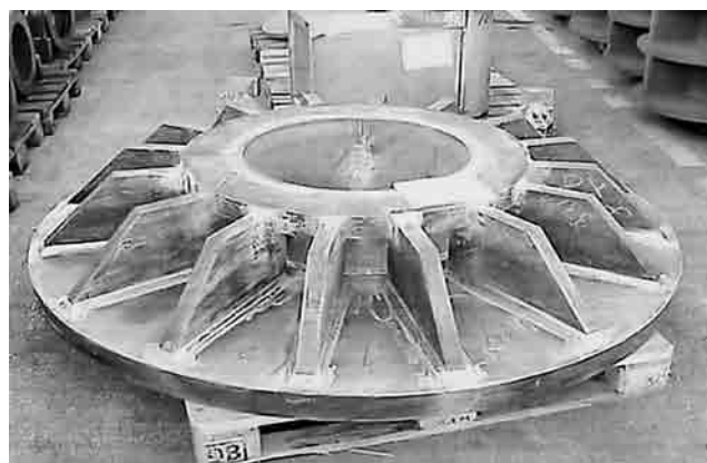
Рис. 9. Соединение разнородных материалов (завод Andritz AG, Австрия)
