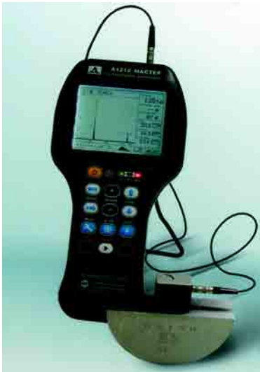
Рис. 29. Ультразвуковой дефектоскоп универсальный серии "Мастер" для неразрушающего контроля металлов
