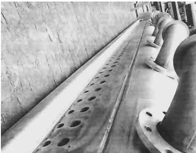
Рис. 6. Паровые душирующие установки для завода Volth Paper Heidenhoim (Германия) из стали 1.4404 (mod.) (AISI 316L), толщина стенки 5 мм. Угловые и V-образные швы со скосом одной кромки сварены с использованием порошковой проволоки Böhler EAS 4M-FD диаметром 1,2 мм
