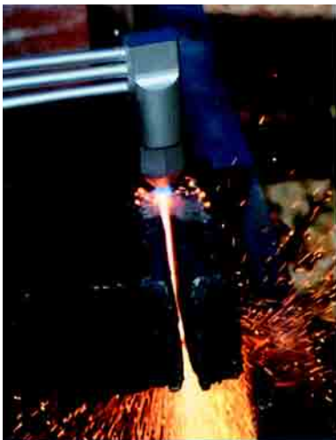
Рис. 22. Трехтрубные резаки РСТ для тяжелых режимов эксплуатации
