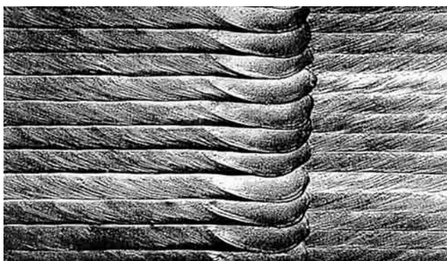
Рис. 11. Наплавка на основной материал — сталь 13CrMo45 (A335, Cr. 911) с использованием проволоки CN 23/12 Mo-FD и EAS-4M-FD диаметром 1,2 мм: I—III — сварочный проход
