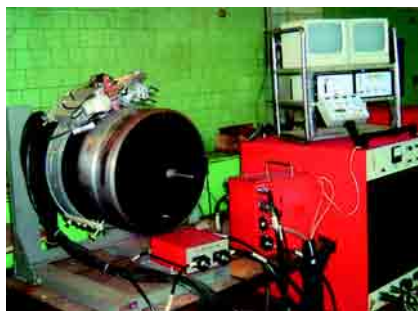
Рис. 9. Сварочный автомат СА-673 для орбитальной сварки с дистанционным управлением
