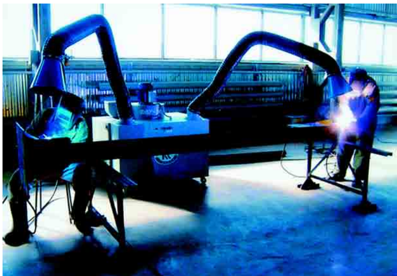
Рис. 26. Рабочее место сварщика на два поста с использованием установки серии ФВУ производительностью 2400 м 3 /ч
