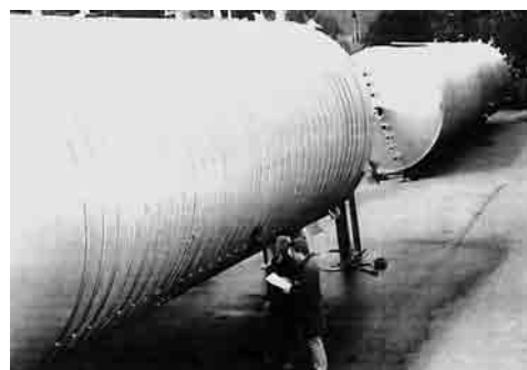
Рис. 4. Бак для хранения химических веществ, изготовленный для завода Apparateban Schweisstechnik (Австрия) из материалов 1.4301 (AISI 304) и 1.4541 (AISI 316Ti), средней шириной 4 м и длиной 20 м, толщина стенок 5 мм, сварен с использованием порошковых проволок Böhler EAS 2-FD и EAS 2PW-FD
