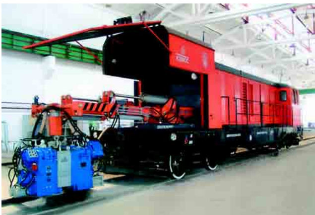
Рис. 30. Модернизированная путевая рельсосварочная машина ПРСМ-3 для контактной стыковой сварки рельсов непосредственно на пути при строительстве и ремонте железных дорог
