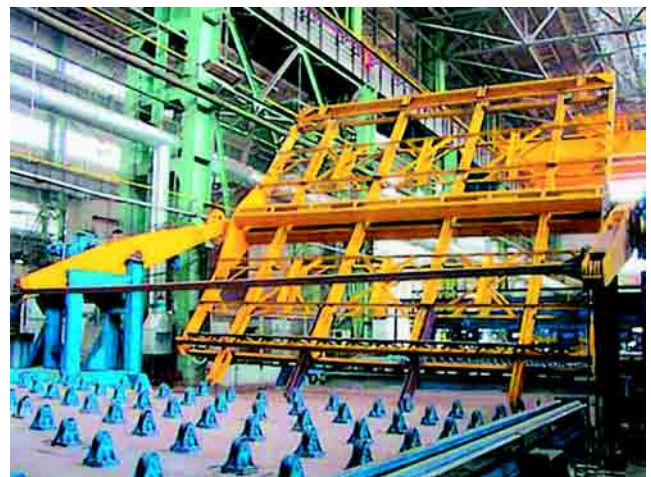
Рис. 31. Стенд автоматической сварки листовых полотнищ со встроенным кантователем
