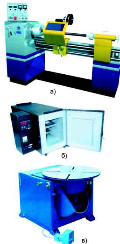
Рис. 10. Установка для электродуговой наплавки тел вращения УН-6М (а), термическое оборудование для сушки и прокалики электродов и флюса (б), универсальный сварочный вращатель ВСУ-3 (в).
