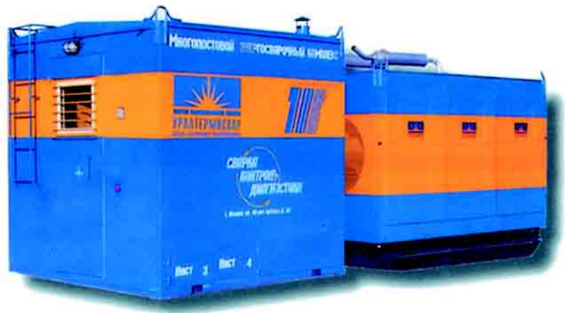
Рис. 16. Комплекс энергосварочный многопостовой КЭСМ-100-4-315 для проведения сварочных работ в полевых условиях
