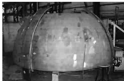
Рис. 2. Сварное днище сосуда
