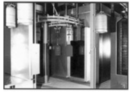
Рис. 16. Оборудование для обработки поверхности: а — комбинированные покрасочные и сушильные кабины; б — дробеструйная обработка и порошковое покрытие газовых баллонов
