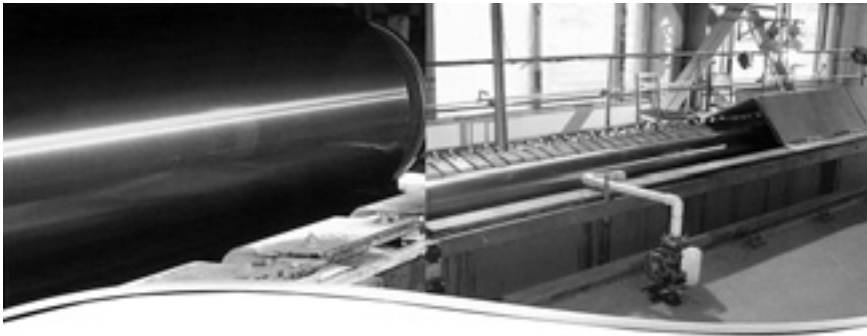
Рис. 3. Оборудование для хромирования при неполном погружении детали в электролит и ее вращении
