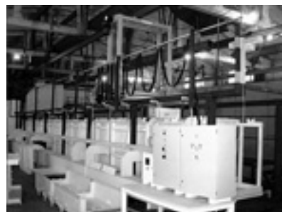
Рис. 2. Гальваническая линия барабанно-подвесочного типа для покрытий любых видов
