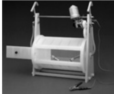
Рис. 15. Мини-ротор барабанного типа для обработки мелких деталей
