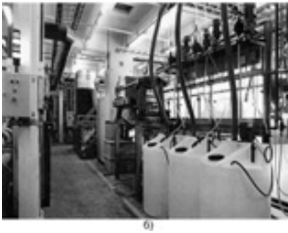
Рис. 14. Гальваническое оборудование: а — подвесочная линия для меднения-серебрения алюминия; б — бессточная водоочистная установка
