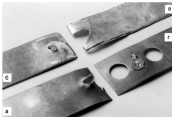
Рис. 2. Сварные образцы после испытания на разрыв: а — М1 + М1 (0,5 + 0,5 мм); б — М1 + М1 (1,0 + 1,0 мм); в — А5 + А5 (1,0 + 1,0 мм); г — М1 + М1 (0,5 + 0,5 мм)
