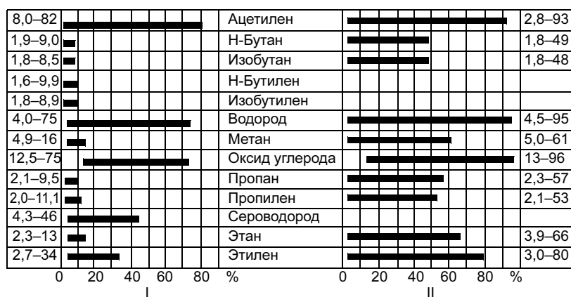
Рис. 4. Пределы воспламенения — объемное процентное содержание (а) горючего газа в смеси с воздухом (I) и кислородом (II) и зависимость (б) воспламенения от соотношения в смеси кислорода и горючего газа: 1 — ацетилен; 2 — водород; 3 — пропан; 4 — метан; 5 — оксид углерода
