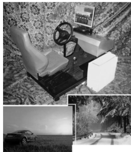
Рис. 2. Компьютерный тренажер вождения легковых автомобилей модели "ВАЗ"
