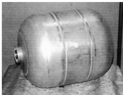
**Рис. 4.** Лейнер баллона высокого давления, сваренный ФС
