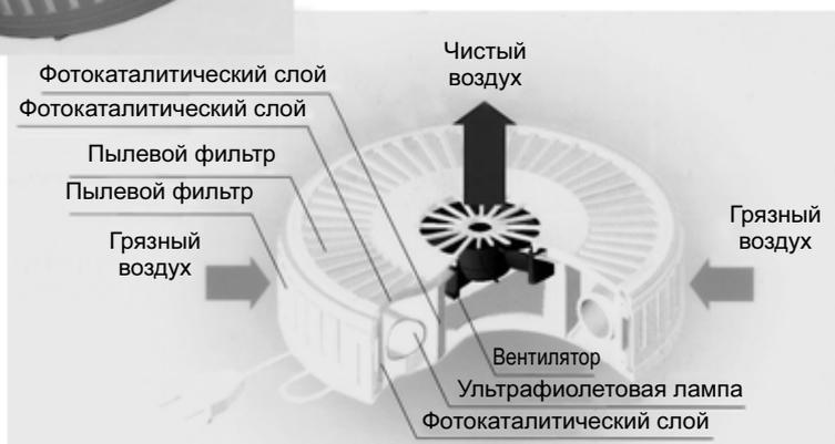
ально новый подход к очистке воздуха от летучих органических и неорганических соединений, обеспечивает наиболее полную очистку воздуха по сравнению с известными методами. В отличие от других фильтров не накапливает загрязнения (реакция фильтрации протекает на поверхности катализатора под действием "мягкого" ультрафиолетового излучения).
