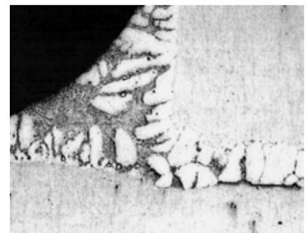
Рис. 6. Соединение сплава АМц, паянное эвтектическим силумином в вакууме в присутствии пористого титана при температуре пайки  $605^\circ\text{C}$  с выдержкой в течение 30 мин.  $\times 50$
