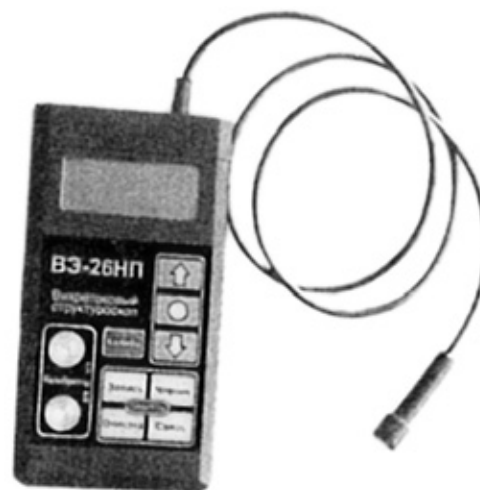
Рис. 2. Вихретоковый структуроскоп ВЭ-26НП
