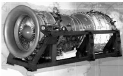
Рис. 5. ГТЭ для производства электроэнергии и тепла
