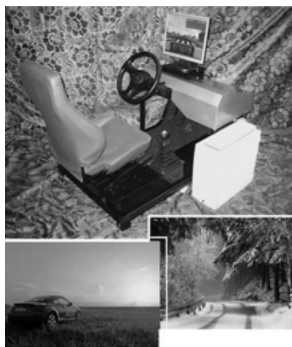
Рис. 2. Компьютерный тренажер вождения легковых автомобилей модели "ВАЗ"
