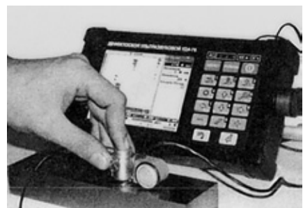
Рис. 10. Снятие В-скана дефектоскопом УД4-76
