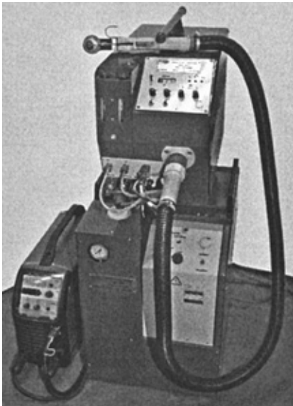
Рис. 6. Полуавтомат ППН-200 для плазменной сварки и наплавки
