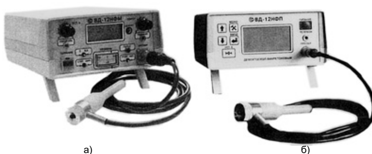
Рис. 5. Переносные вихретоковые дефектоскопы ВД-12НФМ (а) и ВД-12НФП (б)
