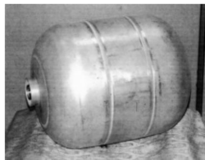
Рис. 4. Лейнер баллона высокого давления, сваренный ФС
