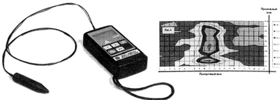
Рис. 3. Портативный двухпараметровый вихретоковый дефектоскоп ВД-89НП, применяемый для выявления и оценки глубины поверхностных трещин на изделиях различной формы из ферромагнитных и немагнитных металлов и сплавов — трубах, отливках, деталях машин — с одновременной отстройкой от влияния зазора до 0,2 мм
