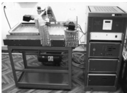
Рис. 2. Лазерная система для контурной размерной резки и точечной перфорации листовых материалов
