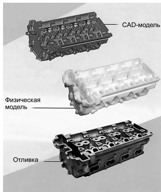
Рис. 1. Схема технологического процесса быстрого прототипирования и изготовления эластичной пресс-формы
