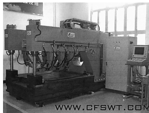
Рис. 5. Установка для СТП FSWJ2XBJ020 (КНР)
