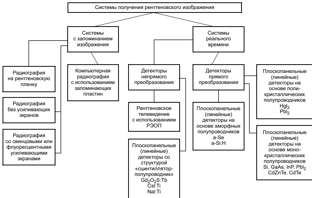
Рис. 3. Схема приемников рентгеновского излучения
