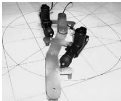
Рис. 7. Мобильный ползающий робот "X-SNAKE"
