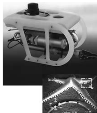
Рис. 4. Новый аппарат "Супер ГНОМ" для выполнения подводно-осмотровых работ на глубинах до 300 м
