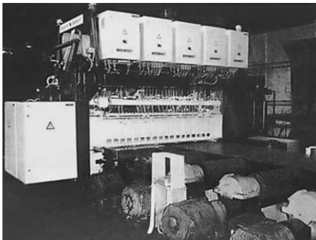
Рис. 3. Установка для автоматизированного УЗК листового проката "Север 6-08-2800" в ОАО "Магнитогорский металлургический комбинат"
