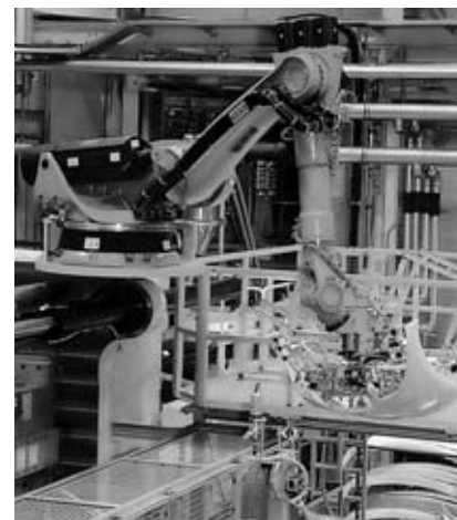
Рис. 1. Шестиосевой промышленный робот нового поколения фирмы КУКА
