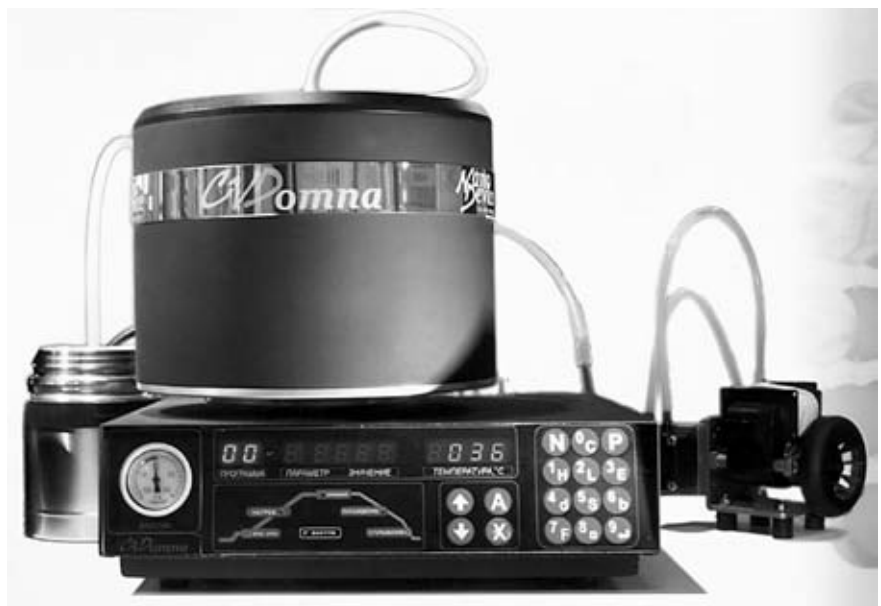
Рис. 7. Учебно-исследовательская установка роста углеродных нанотрубок CVDomna
