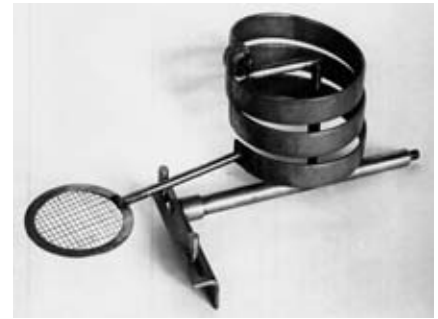
Рис. 9. Устройство для измерения пучков заряженных частиц
