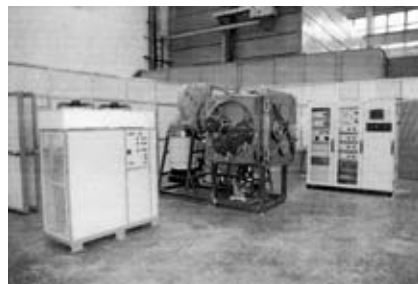
Рис. 5. Установка "Радуга" для ВИПО конструкционных материалов
