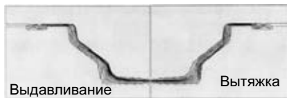
Рис. 4. Сравнение результатов моделирования получения изделия по схемам выдавливания и вытяжки
