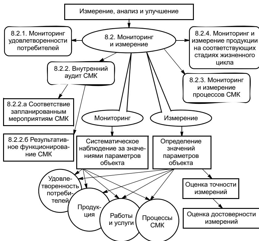
Рис. 2. Структура и смысловое содержание требований по мониторингу и измерениям в СМК по ИСО 9000:2000 (раздел 8)
