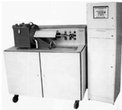
Рис. 6. Установка "Стык-3К" с компьютерным управлением и контролем процесса сварки
